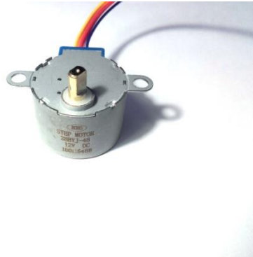
Μικρός βηματικός κινητήρας με εμπορική ονομασία 28BYJ-48. (Εικόνα 1.1)
